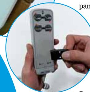
> Pour les télécommandes disposant de l'option verrouillage, passez la clef magnétique devant le symbole du cadenas ouvert pour déverrouiller la commande.
